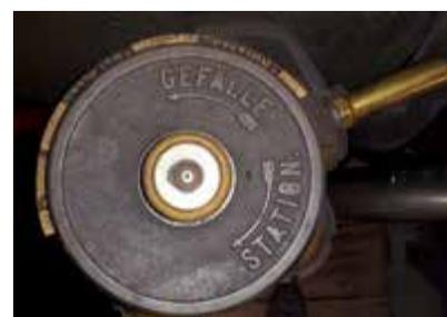
6 Aufsicht des Hardy-Bremschiebers. In Richtung »Gefälle« bremst nur der Zug, in Richtung »Station« Zug und Lok miteinander.
