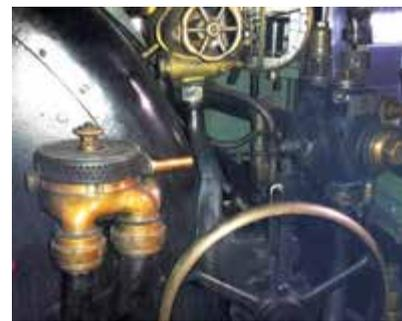
5 Die Vakuumbremse im Führerstand der G 4/5 108. Rechts der Ejektor, der das Vakuum in der Bremsleitung erzeugt, an dessen linker Seite der Bremschieber der englischen Vakuumbremse. Links der Hardy-Bremschieber.
