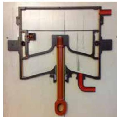
3 Instruktionsmodell des Claytonzylinders in halb gebremster Stellung.
