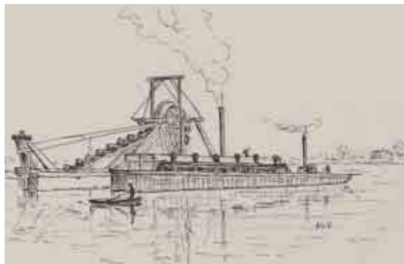
Abb. 46 Dampfbetriebener Eimerkettenbagger mit angedocktem Klappschiff im Schifffahrtskanal Interlaken um 1900 (dort 1891 aus den Beständen der Juragewässerkorrektur übernommen).
