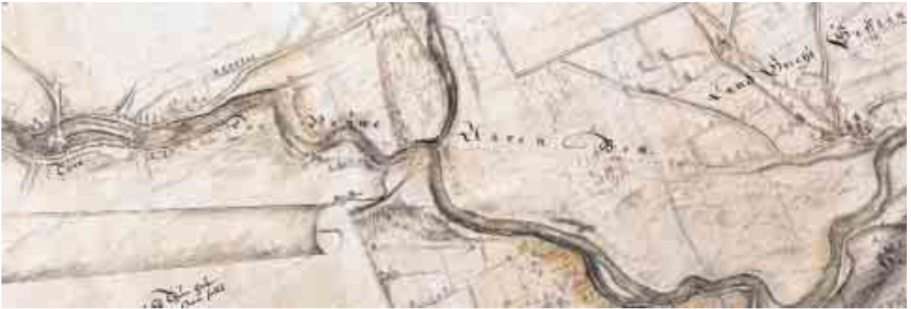
Abb. 127 Plan von Thun und dem anschliessenden Aarelauf sowie der Kander- und Zulgmündung. Strichliert das vorgesehene «Neuwe Aaren Bett» von S. Bodmer, 1710. Fliessrichtung von links nach rechts.
