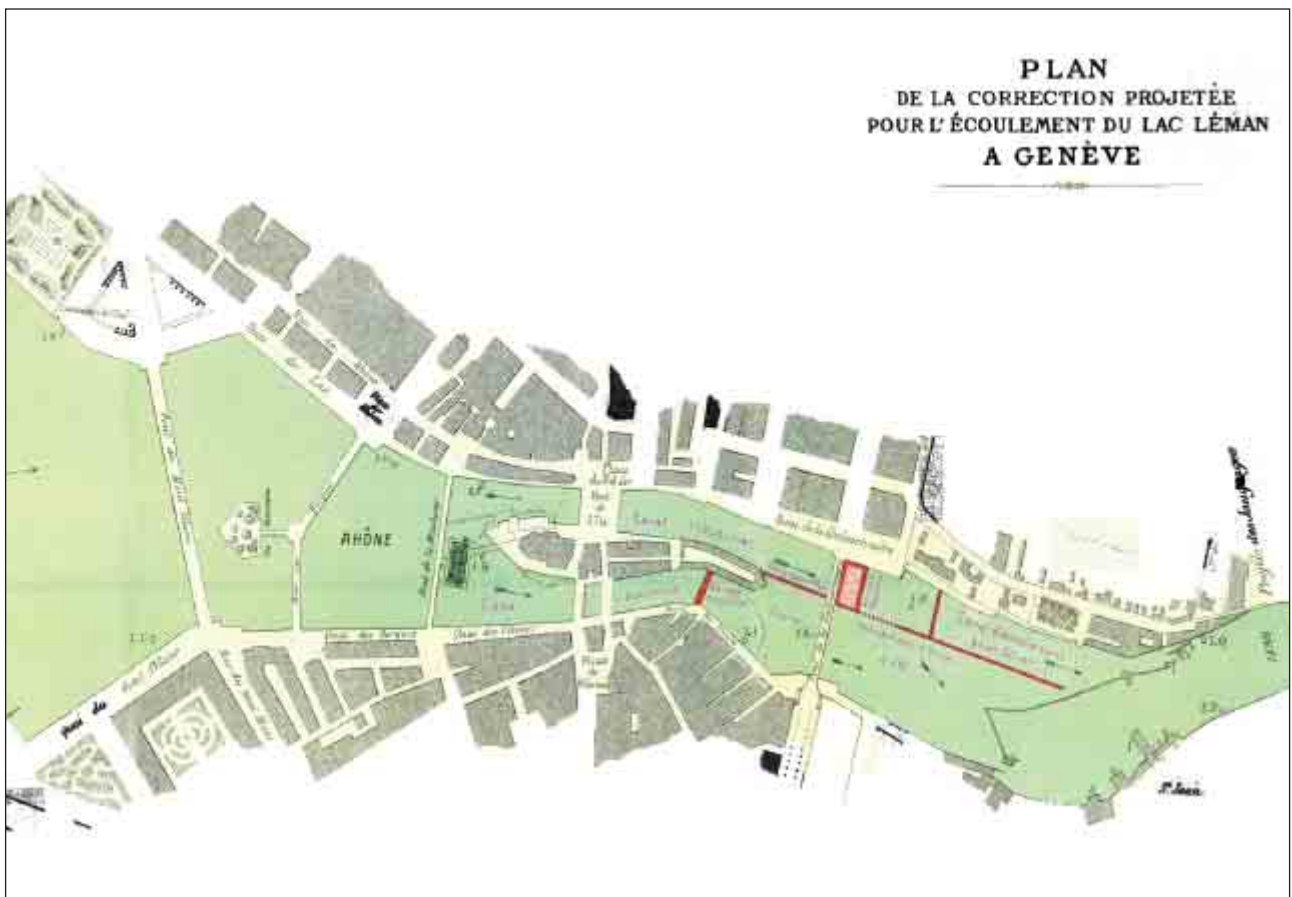
Abb. 193 Situation des Seeauslaufs mit Projekt Pestalozzi/Legler, 1875. Im linken Rhonearm das vorgesehene Pumpwerk, im rechten (am unteren Ende) das vorgesehene Nadelwehr zur Seeregulierung.
