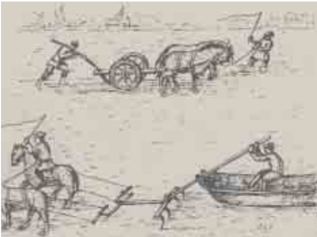
Abb. 44 Geräte zur Auflockerung der Flusssohle. «Dem Sand locker zumachen das solchen das Wasser selbst fortführt.» Zeichnung nach J. Leupold, 1724.
