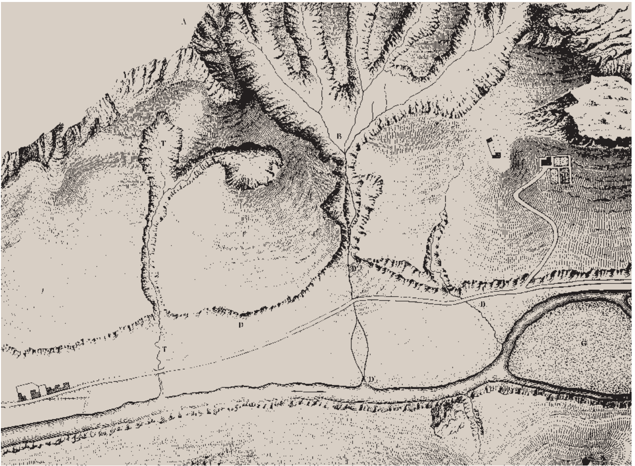
Abb. 147 Erscheinungsbild eines Wildbachs mit Sammelgebiet, Sammelkanal, Schuttkegel und Vorfluter von A. Surell, 1870.
