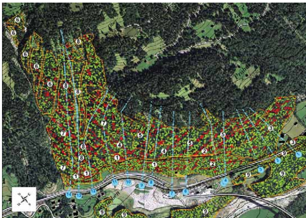
Abb. 8: Waldbestand: Bei der Steinschlagmodellierung berücksichtigte Waldbestände, Pflegeeingriffe und Hangprofile. Grün: verbleibender Bestand, rot: ausscheidender Bestand, orange: Bestandesgrenzen mit Bestandesnummern (weiss), hellblau: Hangprofile mit Nummer (blau).
