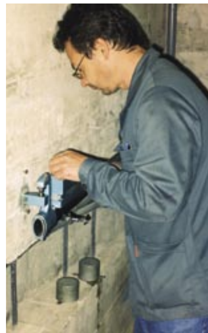
Minutiöse Überwachung der Talsperren: Kontrolle der Mauerbewegungen im Innern der Grande Dixence (links), Sickerwassermessung bei der Anlage Isel GR (Mitte) und Überwachung von Neigungsänderungen der Staumauer Molina GR (rechts).
