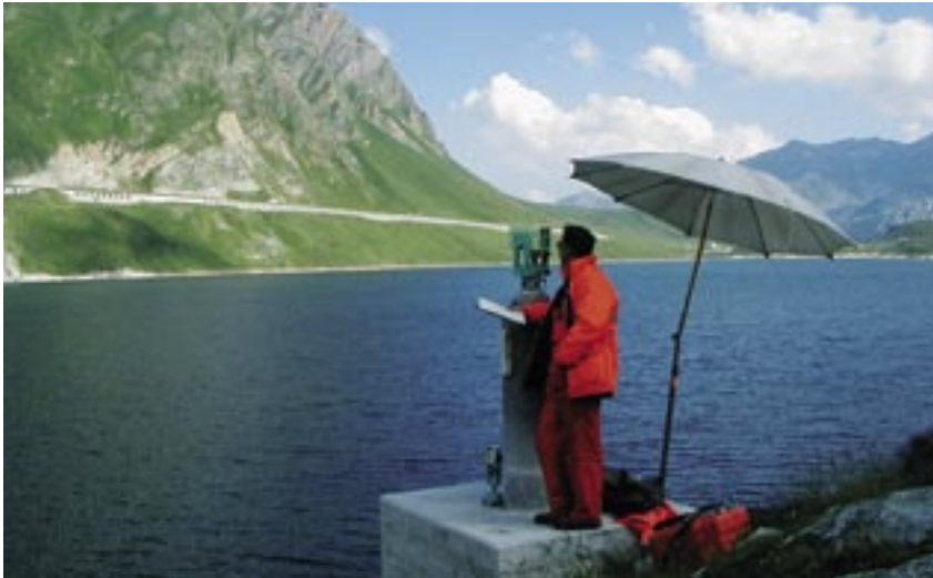
Millimetergenaue Distanzmessung an den Flanken des Speicherbeckens Santa Maria GR.
