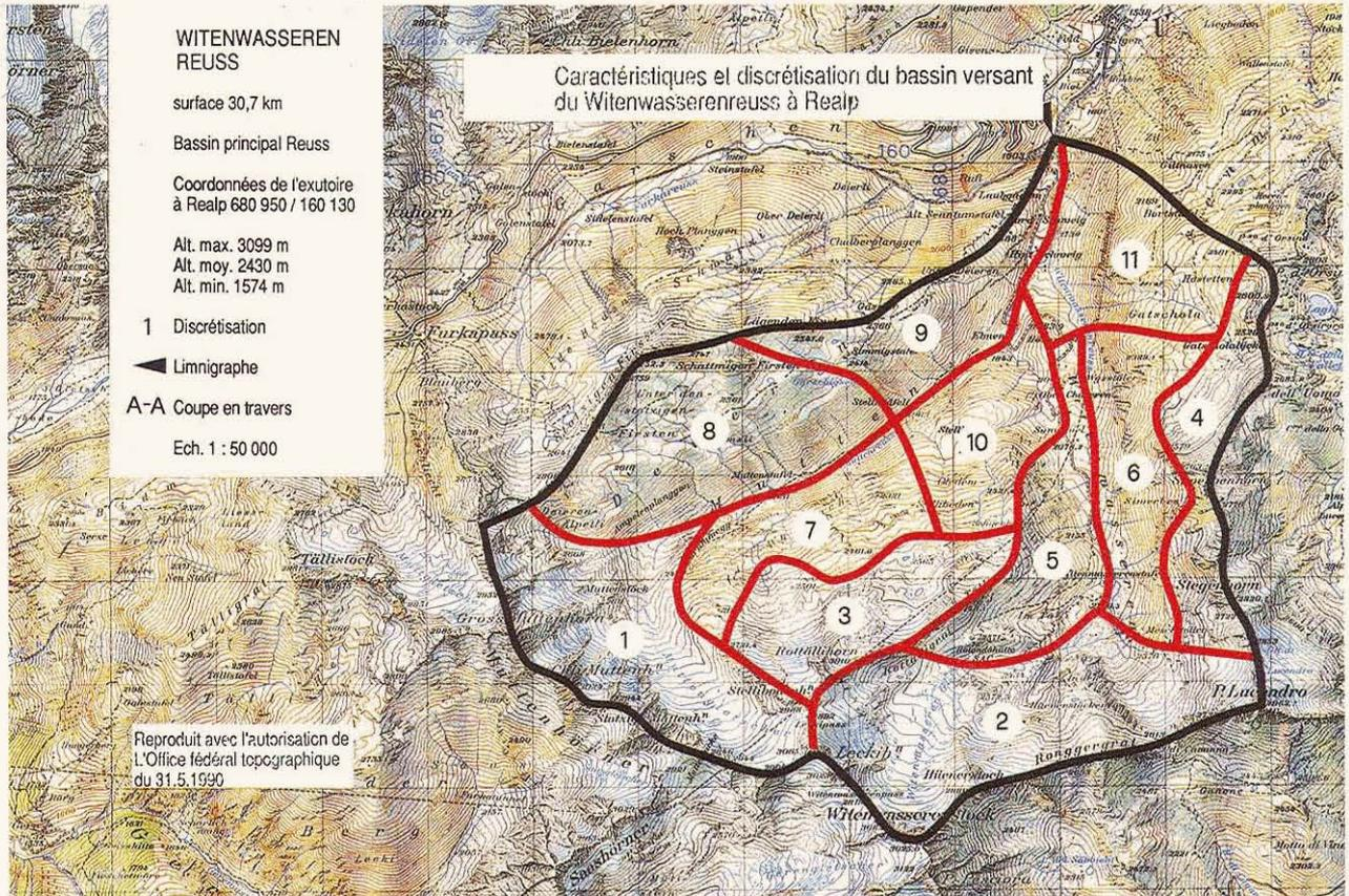
Fig. A-1. Le bassin versant du Witenwasserenreuss et sa discrétisation.
