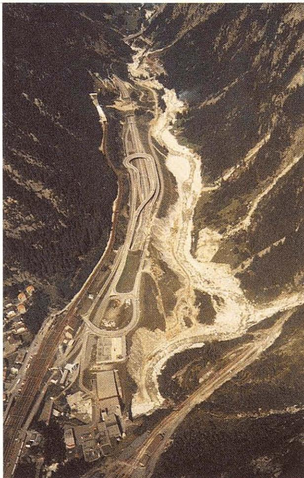
Abb. 16. Poschiavino, Brusio. Die starke Sohlenerosion (ca. 1,5 m) im kanalisiertem Flussabschnitt führte vielerorts zur Unterspülung und zum Einsturz der Ufermauern.
