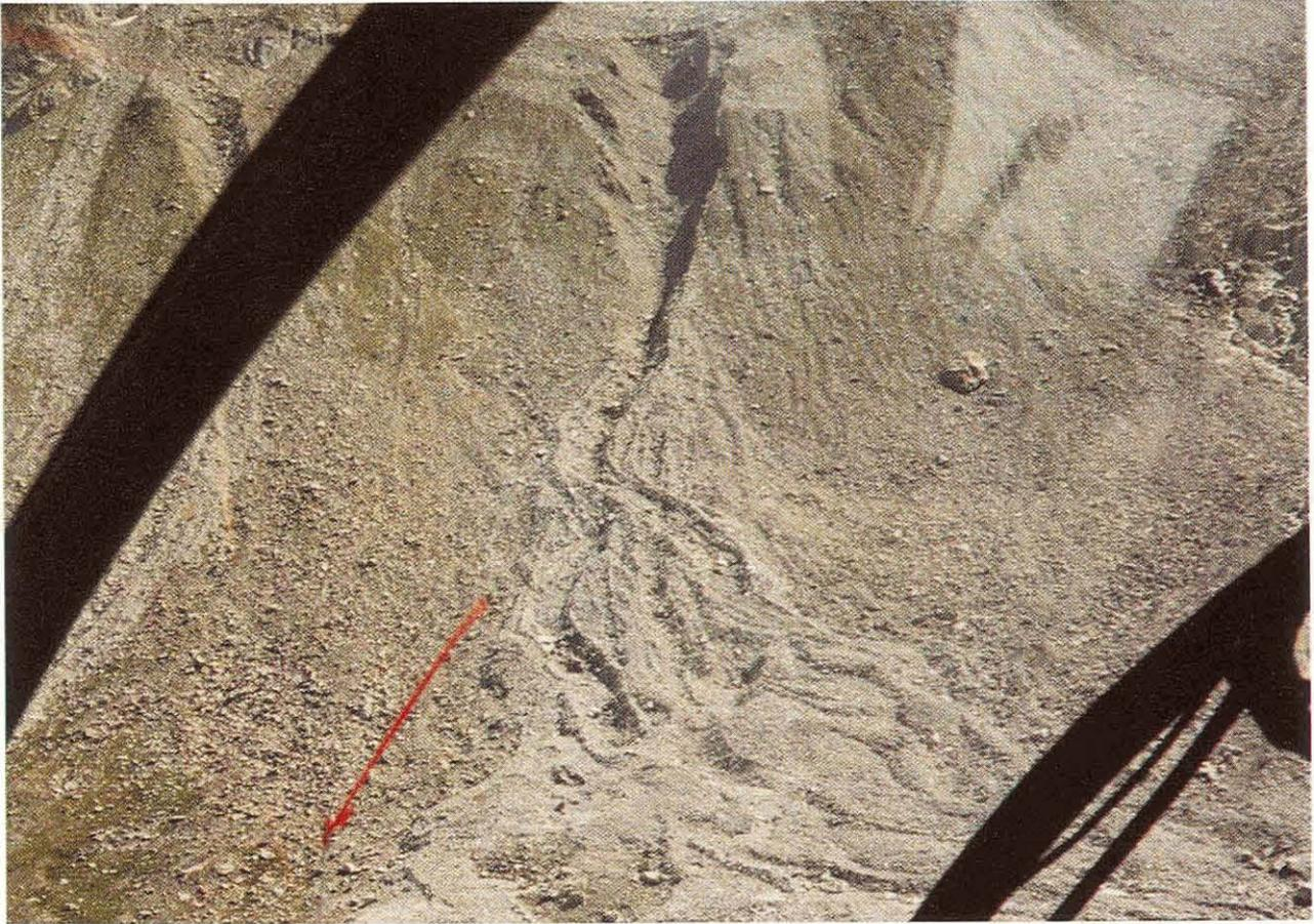
Abb. A5: Murganganriss und Ablagerungen eines Ereignisses vom 24./25. August 1987 im Gerental (Chüeboden). Beim Anriss in der steilen, im letzten Jahrhundert noch gletscherbedeckten Moränenhalde wurden etwa 70000 m<sup>3</sup> Material ausgeräumt; der maximale Erosionsquerschnitt beträgt ca. 450 m<sup>2</sup>, die Länge rund 350 m. Deutlich sind historische Stirnmoränen beidseits der Erosionsform sowie Ablagerungen und Spuren einzelner Murschübe auf dem Kegel zu erkennen.
