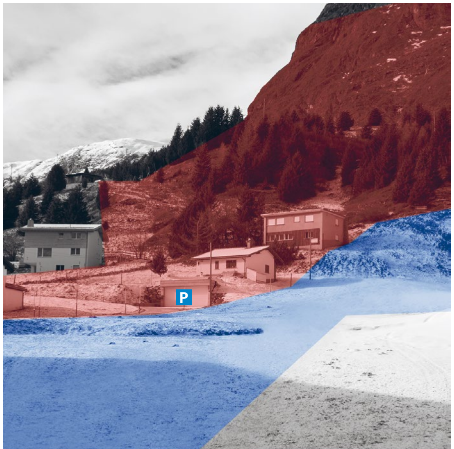
Bivio: Wenn bestimmte Bedingungen eingehalten werden, können An- und Nebenbauten bei Wohngebäuden in der Gefahrenzone 1 (rot) liegen (hier: Ersatz oberirdischer Parkplatz durch unterirdische Garage). (Prozess: Lawine) (Foto: M. Bär, ARE)
