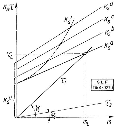
Fig. 103 Scherfestigkeit  $K_s$  und Scherspannung  $\tau$  als Funktion der Normalspannung  $\sigma$  (schematisch).  $K_s^a \dots K_s^d$  Festigkeitskurven für verschiedene Schneearten.  $\tau_1, \tau_2$  Spannungskurven für verschiedene Hangneigungen  $\psi$ . An Hang  $\psi_1$ , Bruch bei  $\tau_L, \sigma_L$ ; an Hang  $\psi_2$  kein Bruch.  $K_s^1$  Festigkeitskurve bei stetig sich verdichtendem Schnee.
