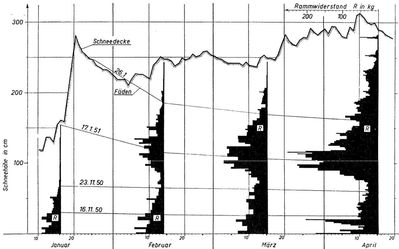
Fig. 105 Verfestigung der Schneedecke auf Weißfluhjoch im Anschluß an die großen Januarschneefälle 1951, veranschaulicht durch Rammprofile
