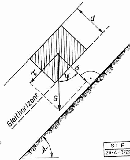
Fig. 102 Aufspaltung des Schneegewichts in Scherspannung und Normaldruck
