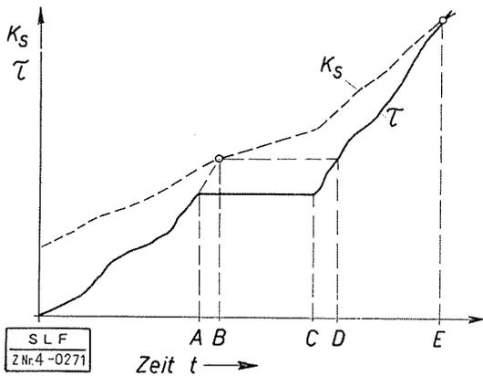
Fig. 104 Scherfestigkeit  $K_s$  und Scherspannung  $\tau$  bei variablem Schneefall in Funktion der Zeit (schematisch). A—C Schneefallpause. B Lawineniedergang ohne Pause, D Lawine ohne Verfestigung während der Pause, E tatsächliche Lawine.
